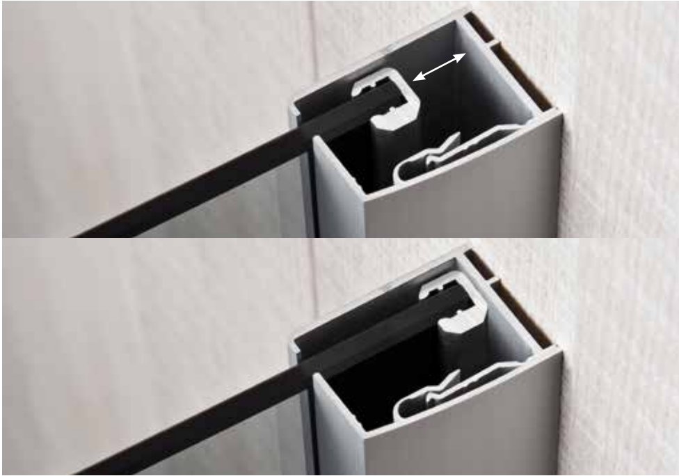
princess 4000 - Indipendentemente dallo spessore del cristallo di 6 mm o 8 mm: dietro alle borchie si nasconde la regolazione di 25 mm.
