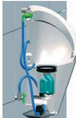
L'orinatoio Lema con risciacquo a 1 litro è disponibile con comando elettronico (a batteria o da 230V per allacciamento alla rete). Rimanendo almeno 8 secondi davanti all'orinatoio si attiva il rilevatore a infrarossi e quando ci si allontana lo scarico si mette in funzione. Se non lo si utilizza, l'orinatoio viene comunque risciacquato automaticamente ogni 24 ore. Il comando è integrato nell'orinatoio, in modo da garantire una facile manutenzione e una protezione antivandalismo.
