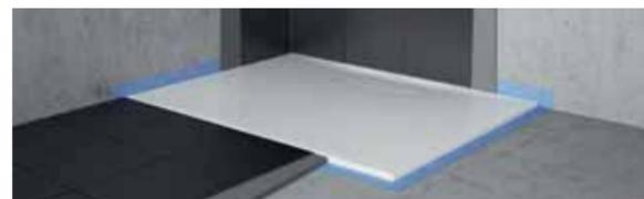
Il **kit di installazione** LAUFEN di materiale espanso consente un'installazione piana di diversi piatti doccia e agevola il relativo isolamento acustico e termico. Una fascetta di protezione che circonda il piatto doccia impedisce in modo duraturo e sicuro la penetrazione di acqua tra le piastrelle e il piatto doccia.
