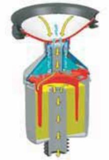
L'evaporazione dell'urina nella «trappola» è praticamente nulla. Anche se l'orinatoio non viene utilizzato per lungo tempo, le emissioni di odori rimangono minime. La poca aria residua che fuoriesce viene a contatto con una pietra profumata al limone. L'orinatoio a 0 litri deve essere pulito regolarmente con acqua in base alla frequenza di utilizzo. L'acqua può defluire direttamente attraverso lo scarico.
