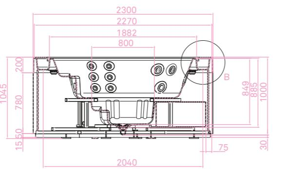
Unterwassermassage, LED-Unterwasser-Farblichtsystem und Warmwasserbereitung garantieren das völlige Wohlbefinden aller Sinne. Minipool ist nämlich mit einem personalisierbaren Unterwassermassage-System ausgestattet: die Intensität der Massage und die Richtung der Wasserstrahlen können reguliert werden. Die Düsen können einzeln eingestellt werden und unterschiedliche Flüsse erhalten: linear, kreisend, soft oder schnell.
