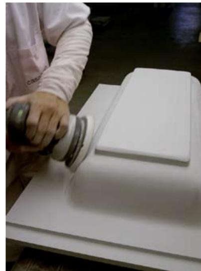
mente calibrati con spessori rettificati e può iniziare la lavorazione di rifinitura manuale, sia per l'interno dei lavabi che per la levigatura finale che avviene con la stessa sequenza di carte abrasive fino alla grana 1500 ad acqua per la finitura lucida.
