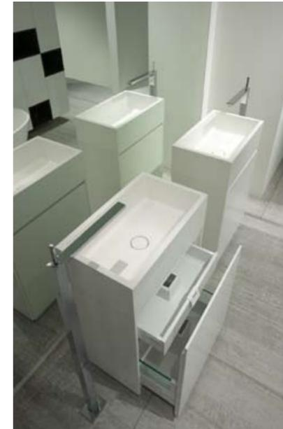
Il portalavabo a sinistra e in alto ha fianchi, frontale e retro realizzati in Monolith così come il lavabo. È dotato di un cassetto e cassetto interno. Le sue dimensioni sono: L58 P35 H87 compreso il lavabo alto 18 cm. Rappresenta una valida alternativa ai lavabi freestanding quando vi sia la necessità di contenimento interno o per soluzioni non convenzionali.
